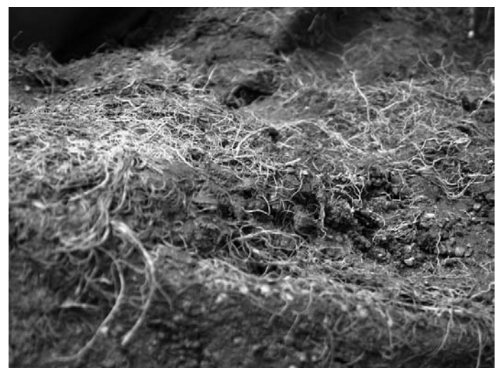
Rys. 11. Kolmatacja geowłókniny pyłem i korzeniami roślin
