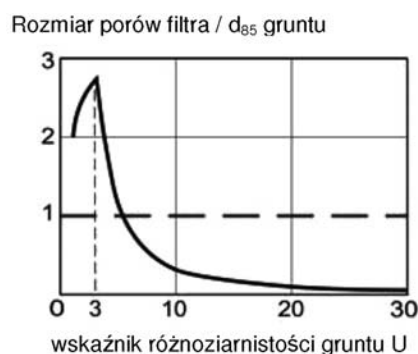
Rys. 4. Kryterium retencji według J. P. Giroud w zestawieniu z kryterium dostosowanym do filtrów odwrotnych [3]
