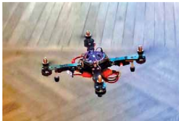
Rys. 13. Quadrocopter w trakcie lotu – widok z góry
