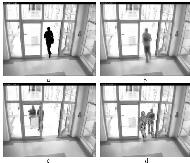
Rys. 1. Anonimizacja prosta obiektów ruchomych z wykorzystaniem algorytmów: a) wycinania, b) rozmywania, c) mozaikowania i d) przesuwania bitowego.
