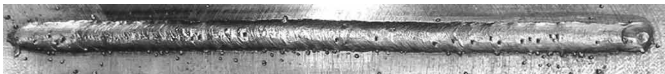
Rys. 9. Napojina wykonana przy nierównomiernym docisku komory do materiału spawanego, energia liniowa 2,5 kJ/mm. Widoczne liczne pęcherze powierzchniowe [3]
