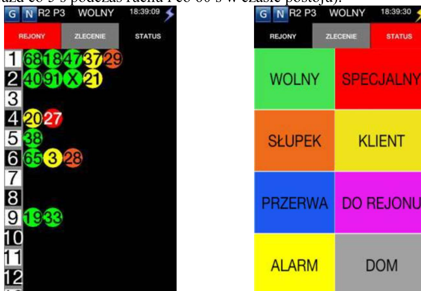
Rys. 2. Widok modułu terminalowego: taksówki w rejonach (przydzielone bezpośrednio) oraz statusy możliwe do przekazania do centrum zarządzającego.
