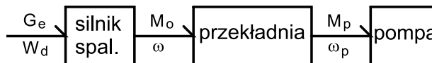
Rys. 3.1. Model układu napędowego pompy hydraulicznej mechanizmu prasującego śmieciarki w formie Grafów Wiązań
