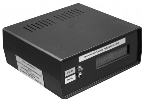
Rys. 7. Model mikroprocesorowego miernika impedancji pętli zwarciowej Fig. 7. Model of the microprocessor loop impedance meter
