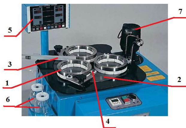
Rys.1. Przykładowy układ wykonawczy docierarki jednotarczowej KEMET15: 1 – pierścień prowadzący, 2 – tarcza docierająca, 3 – układ dawkujący zawieszynę ścierną, 4 – rolki prowadzące pierścieni, 5 – układ sterowania, 6 – dozowniki płynu i ścierniwa, 7 - zespół mieszalnika zawiesziny ściernej [8]
