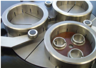
Rys. 2. Standardowy napęd pierścieni prowadzących w docierarce firmy JOKE [7]
