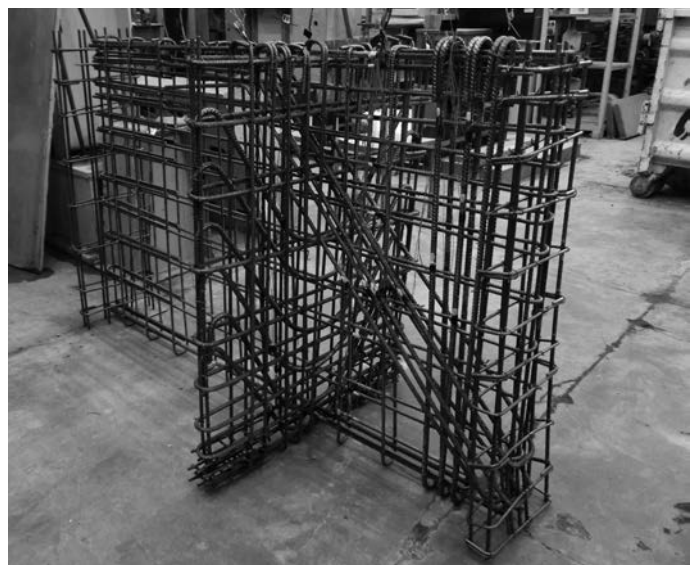
Rys. 4. Zbrojenie tarczy DB-II (z dodatkowym zbrojeniem ukośnym)
