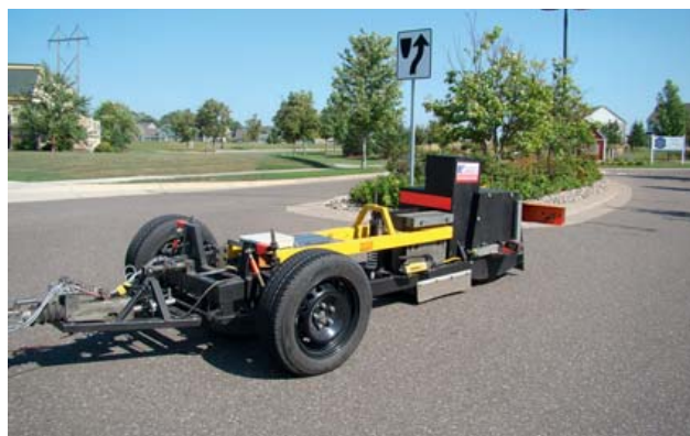
Rys. 6. Przyczepa do badania oporu toczenia R^2 w MnRoad Facility, 2011
