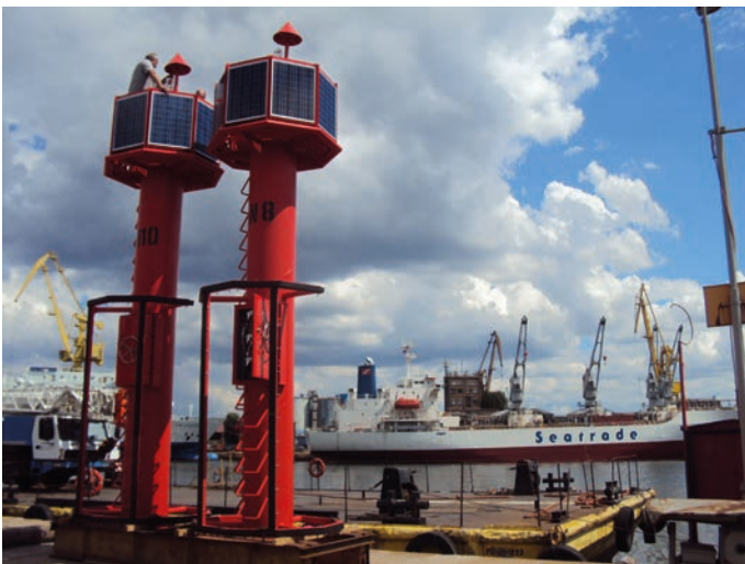
Rys. 14. Górna część pław torowych
