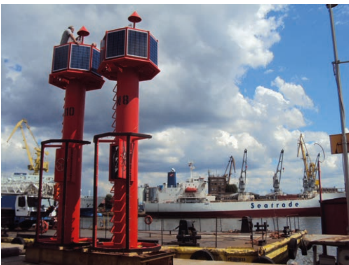
Rys. 14. Górna część pław torowych
