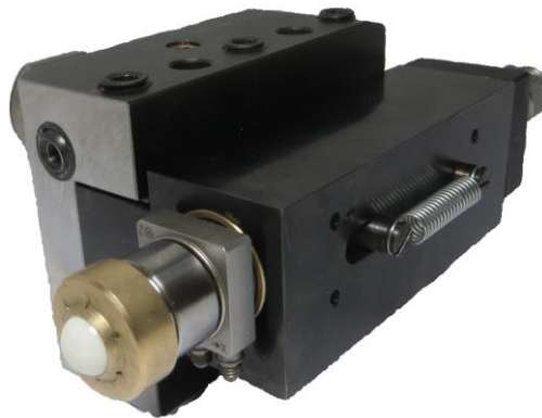
Rys. 1. Narzędzie zastosowane w badaniach z oprawką VDI B6 – 40x25x44
