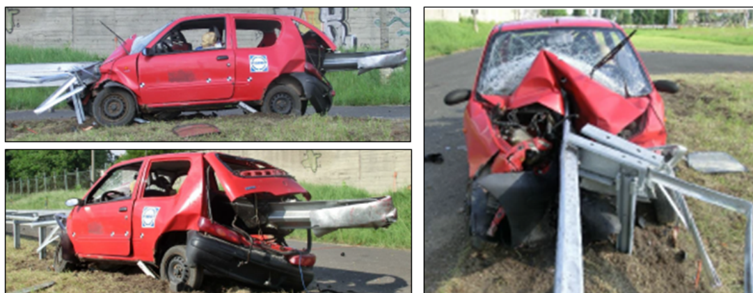
Fot. 2. Skutki najechania pojazdu na niewłaściwie ukształtowany odcinek początkowy [4]
