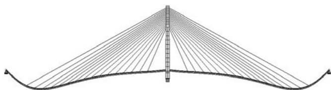
Rys. 6. Przemieszczenia pomostu przed i po naciągu want
