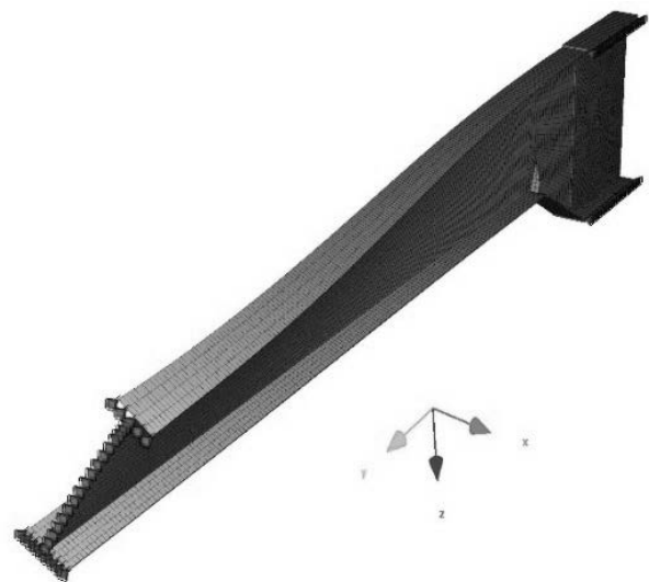
Rys. 9. Postać wyboczenia poprzecznic przy współczynniku 1,02
