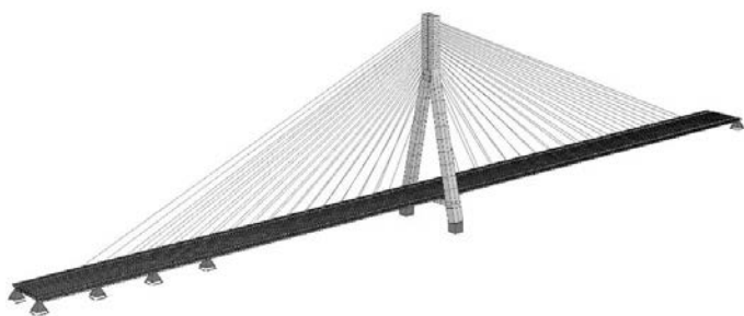
Rys. 5. Wizualizacja modelu obliczeniowego globalnego
