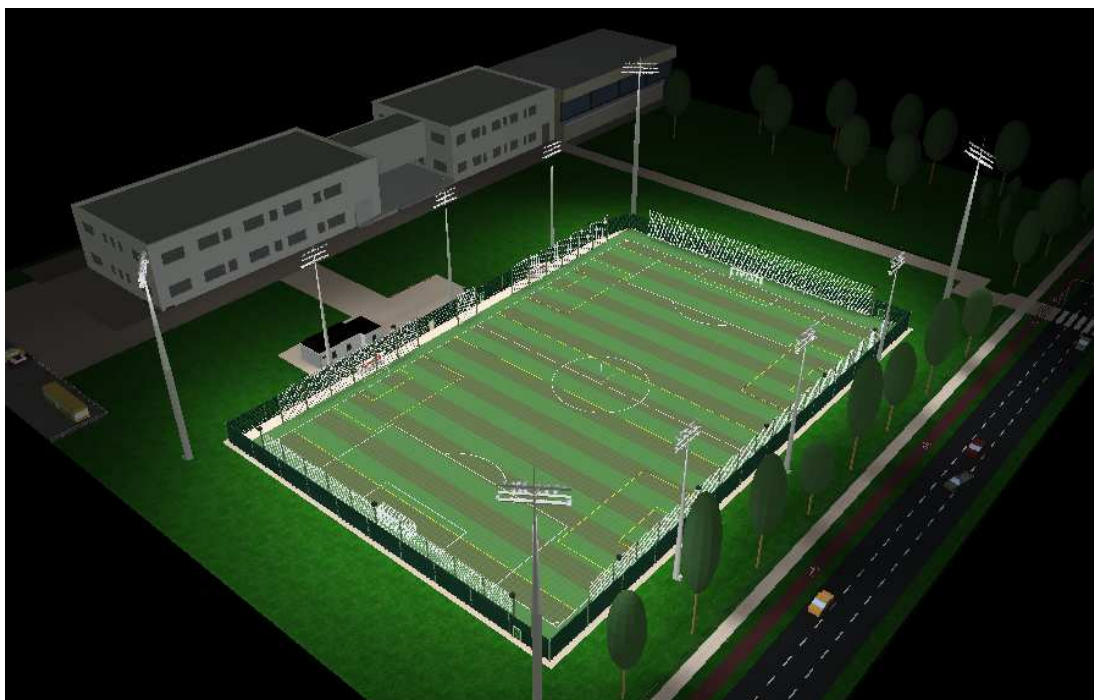
Rys. 4. Wizualizacja oświetlenia boiska dla E_{\text{hsr}} = 1000 \text{ lx}
