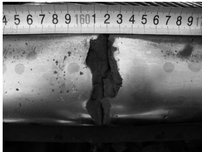
Rys. 11. Złamanie szyny spowodowane rozwojem wady squat
