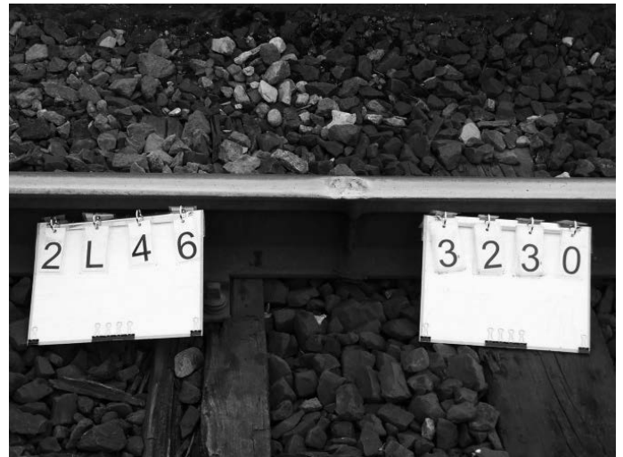
Rys. 6. Wada squat w strefie złącza
