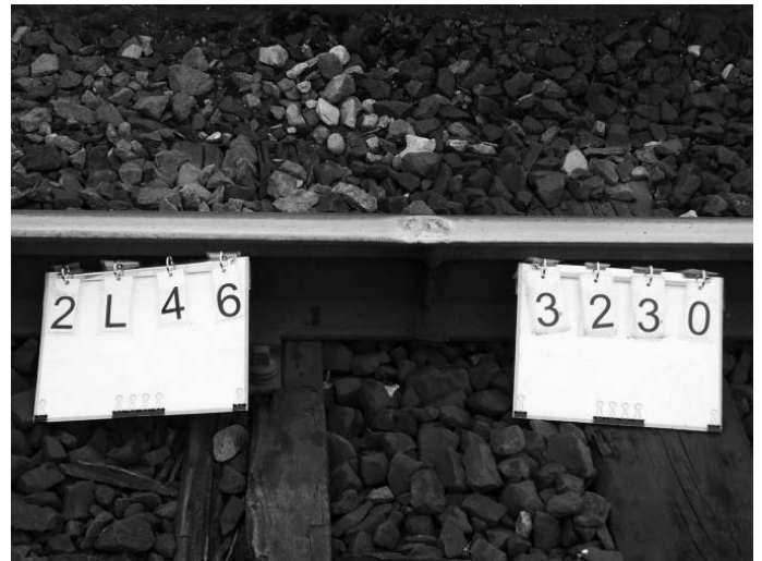
Rys. 6. Wada squat w strefie złącza
