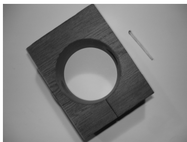
Rys. 9. Element zaciskający czujnik wykonany z tekstolitu (porównanie rozmiarów elementu z rozmiarem zapalki)
