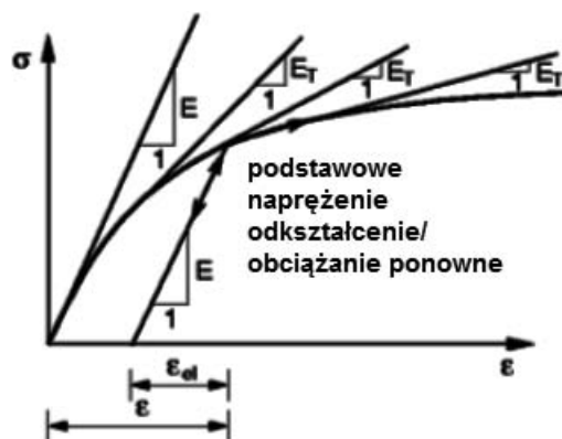
Rys. 5. Wykres naprężenie – odkształcenie dla modeli nieliniowych według [5]
