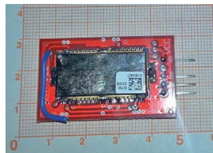
Rys.10. Moduł Bluetooth ATB-BTM-222 Fig.10. Bluetooth module ATB-BTM-222
