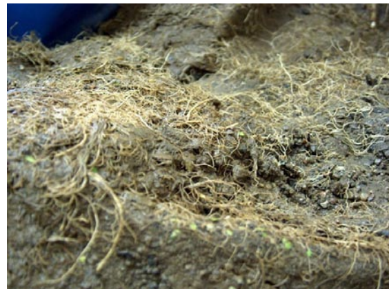
Rys. 8. Kolmatacja geowłókniny pyłem i korzeniami roślin
