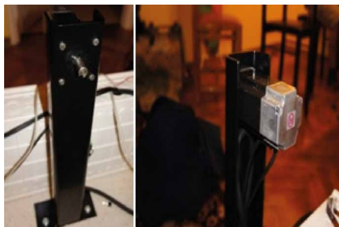
Rys. 3. Serwomotor zamontowany na ceowniku
