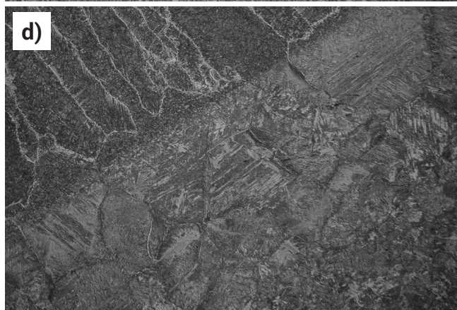
Rys. 10. Struktury w obszarze złączy naprawczych dla: a) próbka 1-0, Q_L=1,50 kJ/mm; b) próbka 2-0, Q_L=1,25 kJ/mm; c) próbka 1-B, Q_L=1,25 kJ/mm; d) próbka 2-B Q_L=1,50 kJ/mm. Pow. 100×
