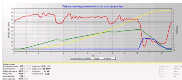
Rys. 8. Sprawny układ hamulcowy. Maksymalne opóźnienie hamowania 8,84 m/s 2 , wartość średniego rozwiniętego opóźnienia hamowania 6,95 m/s 2 , czas hamowania 2,7 s
