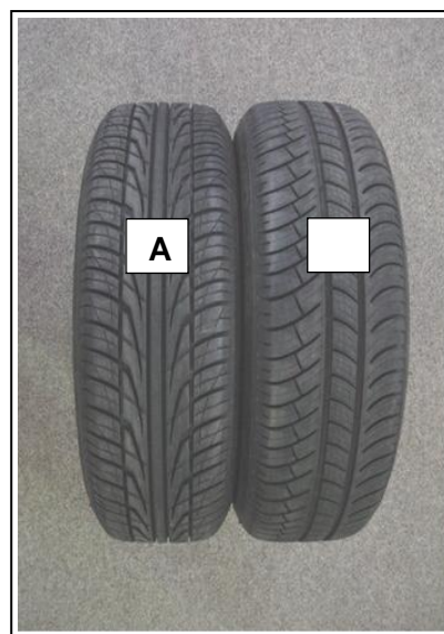
Rys. 1. Opony użyte w teście: A – opona o wysokim oporze toczenia, E – opona o niskim oporze toczenia.
