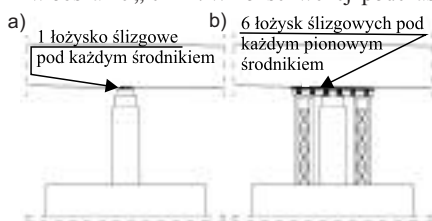
Rys. 4. Widok z boku na filar: a) projekt pierwotny nasuwania; b) projekt alternatywny [4]
