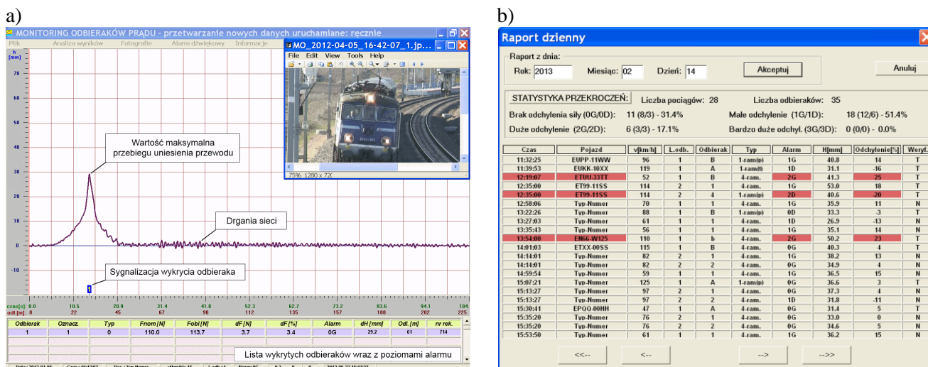
Rys. 5. Przykład wizualizacji wyników w programie przetwarzającym dane: a) okno podstawowe z automatyczną wizualizacją bieżącą; b) okno raportu okresowego
