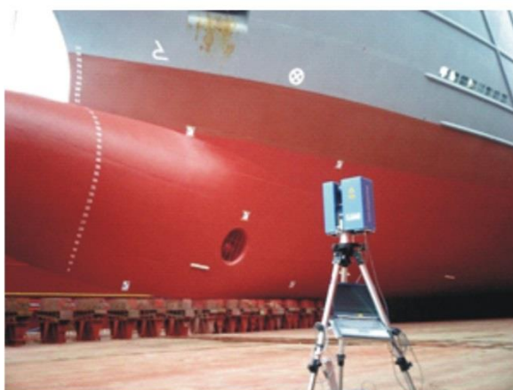
Rys. 5. Pomiaru kształtu rejonu dziobowego statku: a) stanowisko skanera [3], b) uzyskany obraz
