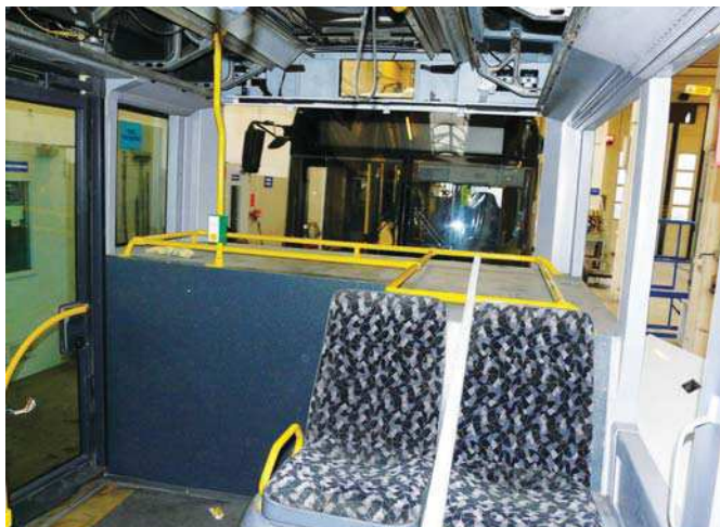
Wnętrze przebudowywanego autobusu Mercedes-Benz O530. Zabudowa dodatkowej przestrzeni na aparaturę elektryczną. Fot. M. Połom
