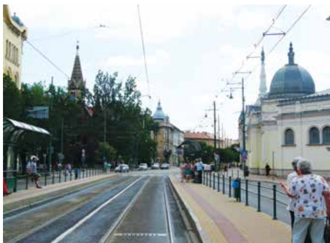
Fot. 5. Wspólny przystanek tramwajowo-trolejbusowy (Segedyn, Węgry): a) widoczne jest boczne zawieszenie sieci trakcyjnej, b) rozdzielenie się sieci trakcyjnej tramwajowej i trolejbusowej wraz ze skrzyżowaniem obydwu trakcji. Fot. M. Bartłomiejczyk
