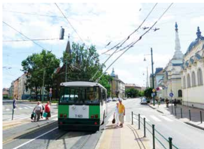
Fot. 5. Wspólny przystanek tramwajowo-trolejbusowy (Segedyn, Węgry): a) widoczne jest boczne zawieszenie sieci trakcyjnej, b) rozdzielenie się sieci trakcyjnej tramwajowej i trolejbusowej wraz ze skrzyżowaniem obydwu trakcji. Fot. M. Bartłomiejczyk
