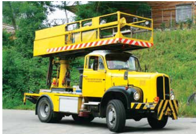
Fot. 2. Zabytkowe, ale nadal eksploatowane, pogotowie sieci w Szauffhausen (Schaffhausen, Szwajcaria). Fot. M. Bartłomiejczyk
