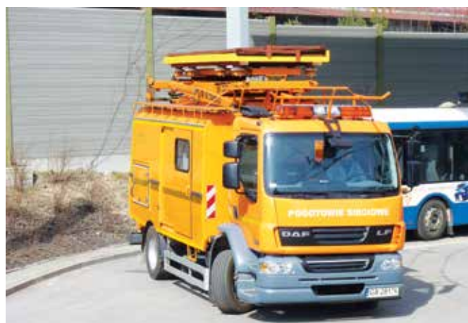
Fot. 18. Pogotowie sieci zmodernizowane w oparciu o podwozie DAF CF55 i wyremontowaną część montersko-wieżową z pojazdu Star 28. Fot. M. Połom
