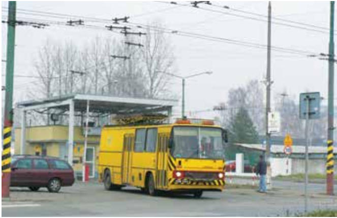
Fot. 5. Tyskie pogotowie sieci, zbudowane na bazie skróconego autobusu Ikarus 280. Fot. M. Połom
