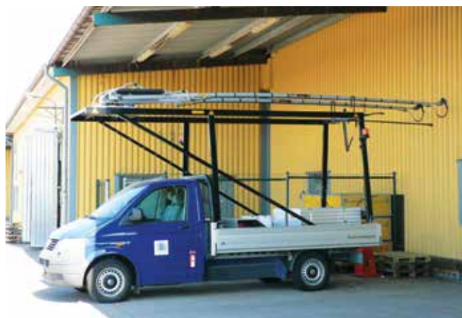
Fot. 13. Pojazd do usuwania oblodzenia sieci trakcyjnej w Landskrona (Szwecja). Fot. M. Bartłomiejczyk
