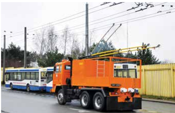
Fot. 11. Holownik (nr 39103 w Gdyni) ze zdemontowanym żurawikiem po przebudowie na specjalistyczny pojazd przeznaczony do usuwania oblodzenia z przewodów trakcyjnych. Fot. K. Grzonka
