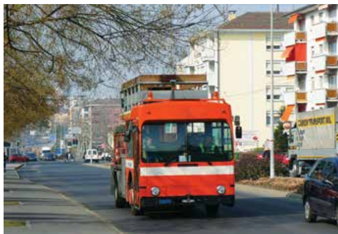
Fot. 8. Pogotowie sieci z nieskładanym pomostem w Lozannie (Szwajcaria). Fot. M. Bartłomiejczyk
