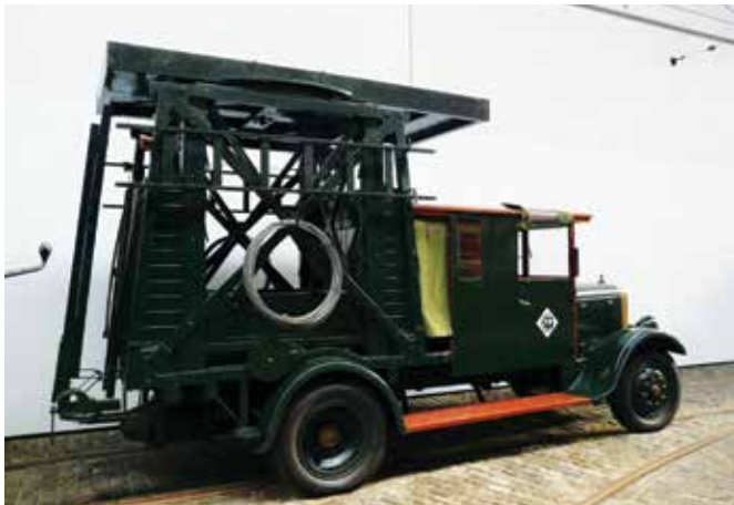
Fot. 1. Ekspонат muzealny z Porto w Portugalii. Zabytkowy pojazd wieżowy wykorzystywany w komunikacji trolejbusowej tego miasta. Fot. M. Bartłomiejczyk
