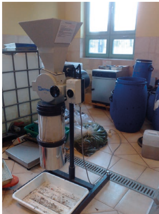
Rys. 1. Młynek tnący (Retsch SM100, Niemcy)
