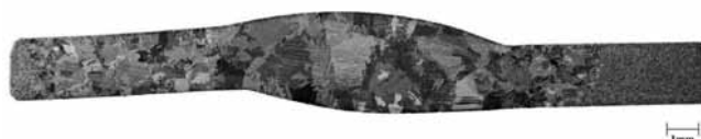
Rys. 6. Zgląd makroskopowy złącza próbnego, trawienie HCl/HF Fig. 6. Macro section of welded specimen, etching HCl/HF
