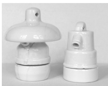
Rys. 8. Porównanie z konstrukcją typową (mimo różnych producentów, wszystkie elementy są wzajemnie wymienne)
