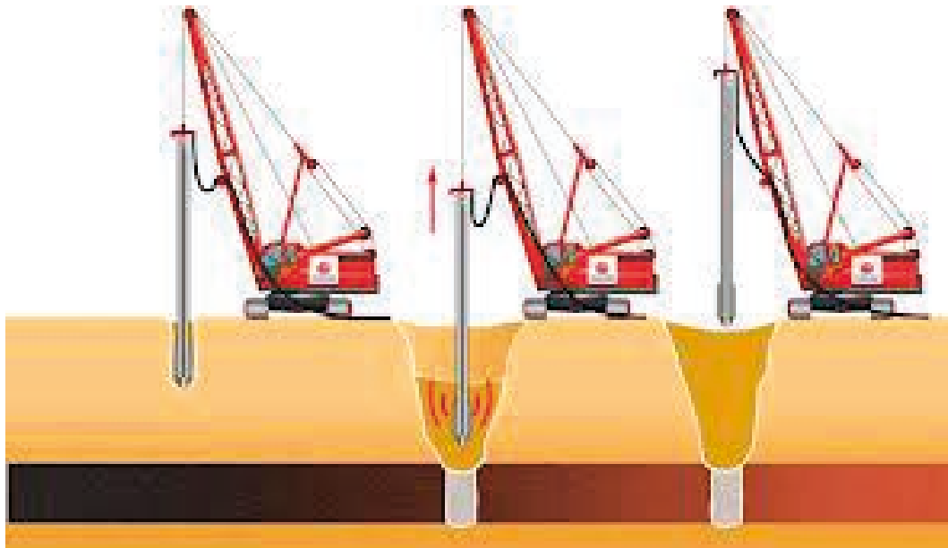
Rys. 2. Schemat wykonywania kolumn MMC
