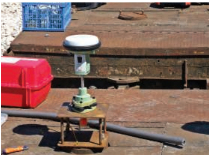
1. Odbiornik satelitarny Leica Viva GS 15 zainstalowany na wózku (kampania pomiarowa 2015)
