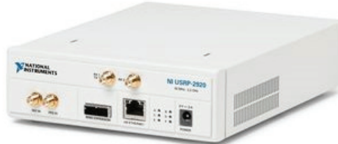
Rys. 4. Widok platformy sprzętowej radia programowalnego NI USRP [5]
