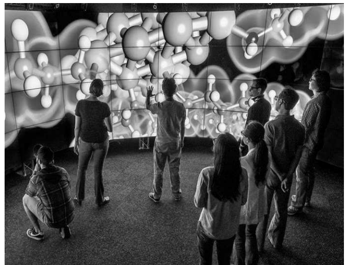
Rys. 1. Przykład systemu wizualizacji CAVE (źródło: http://scifundchallenge.org/firesidescience )
