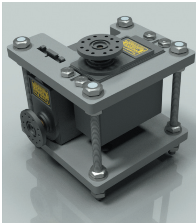
Rys. 1. Podstawka pod serwomechanizmy ze wszystkimi elementami łączącymi
