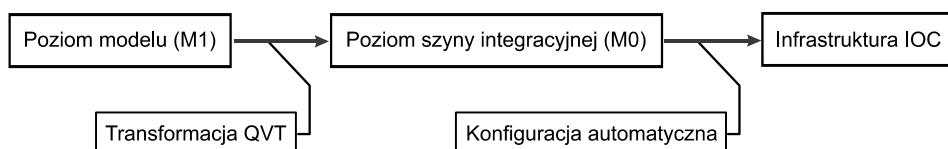
Rys. 3. Proces konfiguracji szyny IOC: przejście z poziomu modelu poprzez poziom szyny integracyjnej
