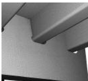
Rys. 5. Szczegółowy model MES pomostu ortotropowego Fig. 5. Detailed FEM model of the orthotropic deck
