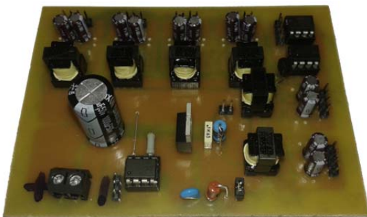
Rys. 2. Widok prototypu wielotransformatorowej przetwornicy typu Flyback
