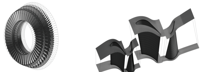
Rys. 1. Widok trójwymiarowego modelu analizowanych stopni turbinowych oraz widok numerycznej siatki kanału przepływowego
