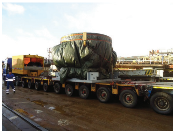
Rys. 3. Przekładnia typu MAAG WPU załadowana na specjalną naczepę [14]
