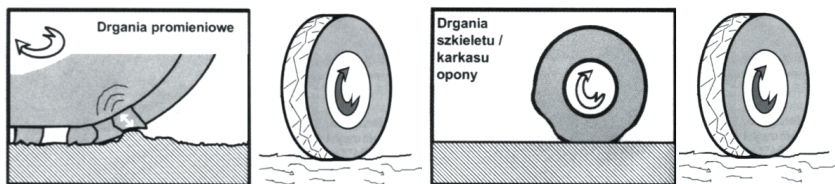
Rys. 4. Drgania promieniowe i styczne bieżnika opony przy ugięciu (po lewej) i drgania szkieletu opony (po prawej)
