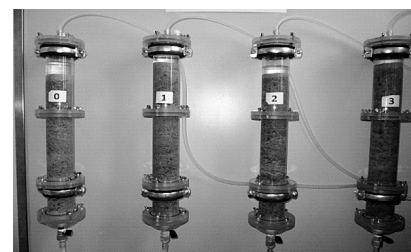
Widok ogólny kolumn filtracyjnych (PVC) wypełnionych betonem z popiołem lotnym: nr 0 – 0%, nr 1 – 15%, nr 2 – 25% oraz nr 3 – 40%
