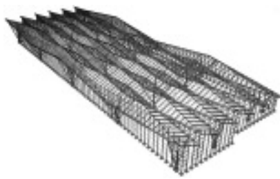
Rys. 2. Globalny model MES Terminalu (SOFiSTiK)
