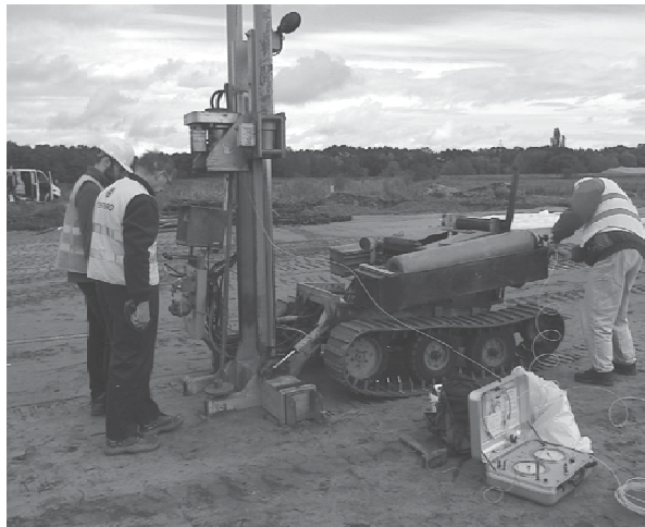
Rys. 2. Badania dylatometryczne na platformie roboczej
