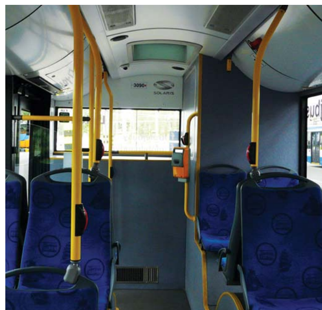
Fot. 4. Wnętrze tylnej części trolejbusu Solaris Trollino 12 z widoczną wieżową zabudową mieszczącą w sobie moduły bateryjne
