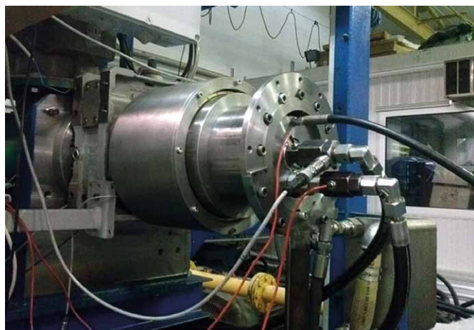
Rys. 13. Silnik SWK-4/6-1,5/6 na stanowisku badawczym - testy silnika przy n = 1 obr./min
