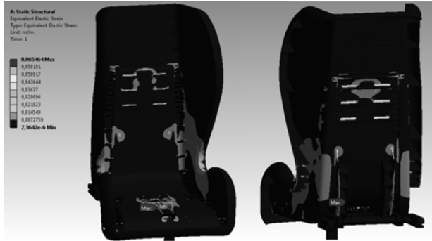
Rys. 7. Wyniki analizy: odkształcenia zredukowane, widok aksonometryczny z przodu i z tyłu (skala odkształceń 1:1) [1]
